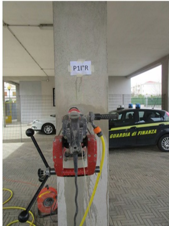
particolare carotaggio su pilastro a piano terra
