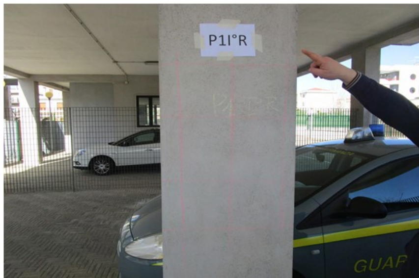
particolare prova pacometrica prima del carotaggio per individuazione delle armature
